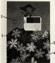
Рис. 2. Цветной тест-объект, которым служила красочная открытка с вытравленной шкалой серых тонов: 1 — красный; 2 — зеленый; 3 — желтый; 4 — голубой цвет.
